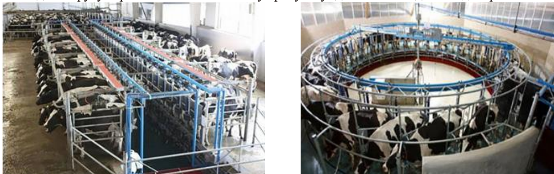
Рис. 4. Типи доїльних залів: а – паралельний доїльний зал Midiline, Delaval, Швеція; б – ротаційна доїльна зала HBR, Delaval, Швеція
